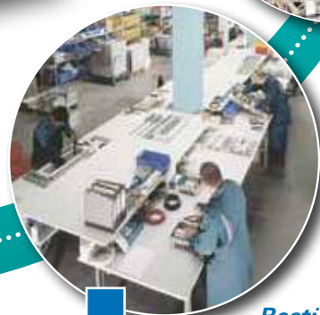
Bestückung und Verdrahtung von elektrotechnischen Verteilern und Baugruppen
